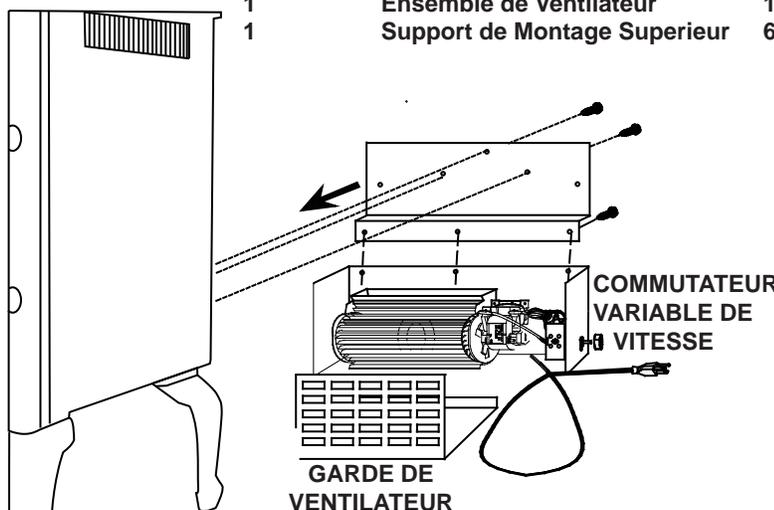
Votre ensemble de ventilateur EP62-1 vient avec un interrupteur de vitesse variable servant à faire partir et arrêter le ventilateur ainsi qu'à contrôler sa vitesse.
